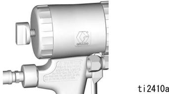
13. 段ボールに試験スプレーを行なってください。良好なスプレーパターンを実現する最低液体圧力になるように、エアレギュレーターを調製します。
